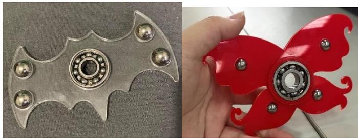
本課程以 Autodesk AutoCAD 2023 電腦繪圖軟體進行創意設計，搭配雷射切割機完成作品製造，再裝配滾珠軸承做為轉軸，搭配鋼珠以增加旋轉時的慣性力，完成獨創性且具個人化的作品。
